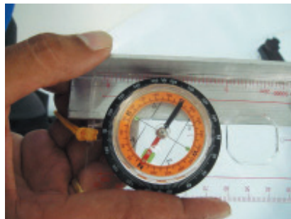
6. สายหน้าจานจนเข็มชี้สีแดงมาตรงกับตำแหน่ง N ของวงในสีส้ม
