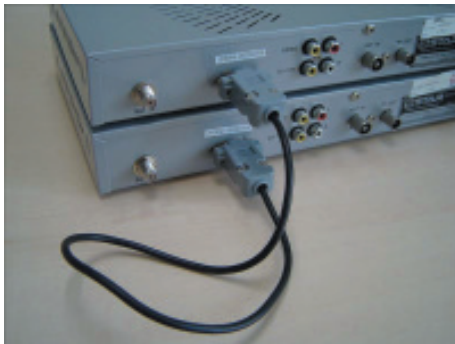
เครื่องด้านบนคือตัวลูก เครื่องด้านล่างคือตัวแม่
