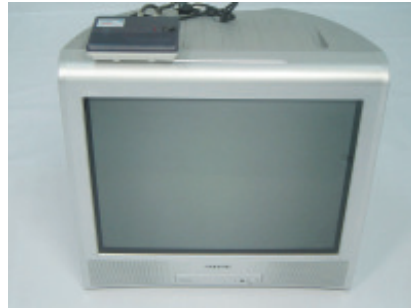
9. นำกล่องตัวรับไปไว้บนหลังทีวี เพื่อเป็นจุดรับสัญญาณจากรีโมท
