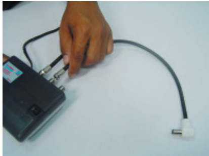
7. ต่อสายเข้าที่ To TV ของตัวรับ (Receiver)
