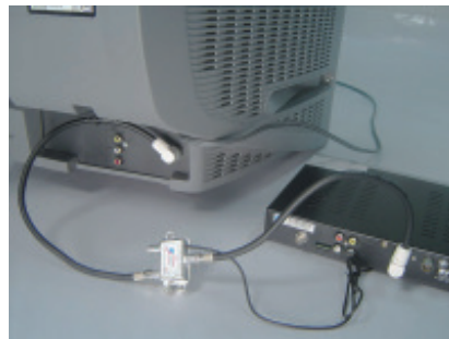
5. ต่อสายระหว่าง TV1 ของตัวส่ง (Transmitter) กับ ANT IN ของทีวี (ห้องรับแขก)
