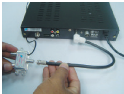
2. ต่อสายระหว่าง RF OUT ของรีซีฟเวอร์กับ IN ของตัวส่ง (SAT-CONNECT)
