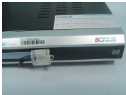
3. นำกล่องอินฟาเรดติดไว้ที่ด้านหน้าของรีซีฟเวอร์ โดยให้ติดใกล้กับจุดรับสัญญาณรีโมท
