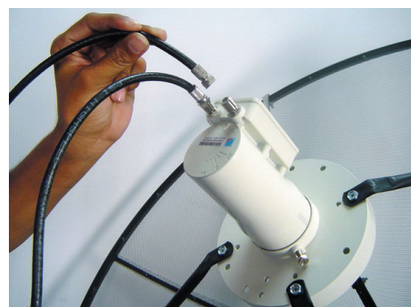
12. นำสายนำสัญญาณเส้นที่ 2 ต่อเข้ากับ LNB
