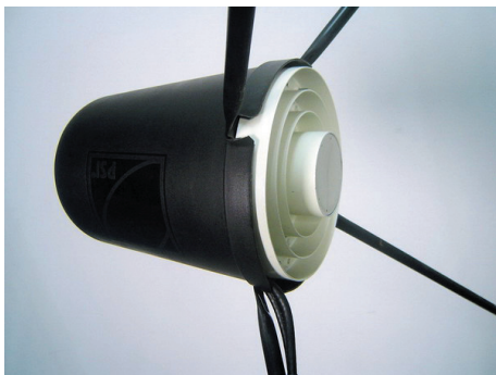
15. รูปเมื่อติดตั้งหมวกครอบ LNB เรียบร้อยแล้ว
