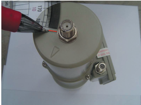
5. ขีดเส้นให้ชัดเจนที่ตัว LNB (ค่าตัวเลข 240 ที่ได้จากเครื่องมือช่วยปรับโพลาไรท์)
