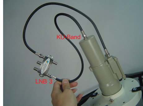
14. ต่อสายนำสัญญาณระหว่าง LNB KU-Band ต่อเข้ากับสวิตช์ DiSEqC 4x1 ในช่อง LNB 3
