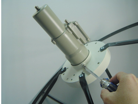
11. ทำการขันสกรูยึด LNB ให้แน่น
