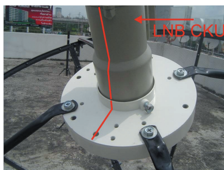
9. ให้ปรับ LNB โดยให้เส้นที่ขีดด้านข้างของกระบอกตรงกับตำแหน่งด้านล่างของสกลาลำรั้ง
