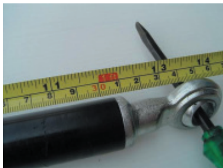
15. โดยปกติถ้าติดตั้งจานรุ่น D2/D185 จะปรับความยาวยึดออกสุดที่ 32 เซนติเมตร แต่ถ้าต้องการรับดาวให้มากขึ้น ก็กดปุ่มบังคับทิศทางขวาที่รีโมทให้ แกนยึดออกได้อีกแต่ต้องไม่เกิน 40 เซนติเมตร
