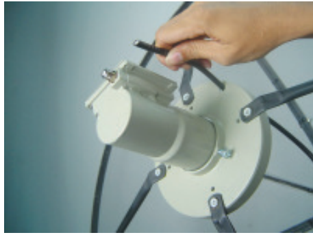
25. สอดสาย RG-6 ผ่านรูของสกาล่าร์ริง
