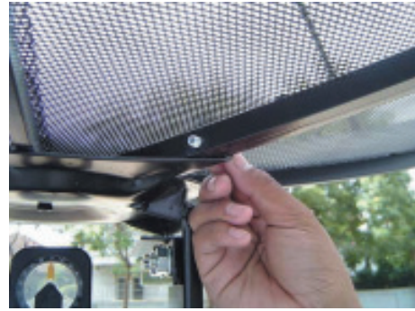
16. ใส่สกรูและน็อตยึดกับคอกจาน และอย่าลืมรองแหวนด้วยทุกครั้ง
