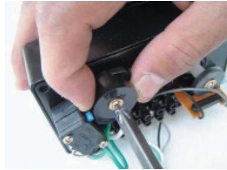
17. ต้องปรับตั้งใหม่โดยใช้นิวซี และนิ้วโป้งจับลูกเบี้ยวให้แน่นก่อน แล้วใช้ไขควงแฉกหมุนทวนเข็มนาฬิกาเพื่อคลายสกรูออก ข้อควรระวัง การขันสกรูตัวนี้ทุกครั้งจะต้องจับลูกเบี้ยวไว้ก่อนไม่เช่นนั้นจะทำให้เฟืองพลาสติกด้านในหลุดเสียใช้การไม่ได้
