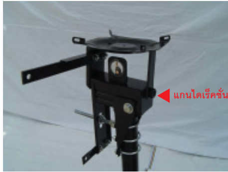
13. นำตัววัดมุมไปติดตั้งที่ตำแหน่งแกนไดเรกชั่น (direction)
