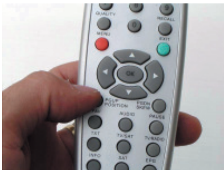
3. เปิดทีวีให้เป็นมอนิเตอร์ แล้วกดปุ่มที่รีโมท PGUP 1 ครั้งแล้วปล่อย
