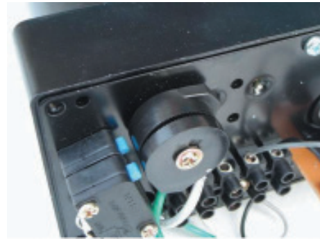
18. เมื่อคลายสกรูแล้ว ลูกเบี้ยวตัวในและตัวนอกตรงรอยประกบกันจะมีร่องฟันเล็กๆ อยู่ เพื่อทำไว้ให้ตั้งได้
