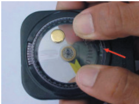
14. ปรับตำแหน่งให้ถูกต้องก่อนนำไปใช้งาน โดยการเช็ทค่าให้ตำแหน่งมาร์คตรงกับเลข 0 หรือว่าถ้าต้องการวัดกลับ ก็ต้องให้มุมด้านล่างที่ลูกศรชี้ไปตรงกับมาร์คเลข 0 ก็ได้
