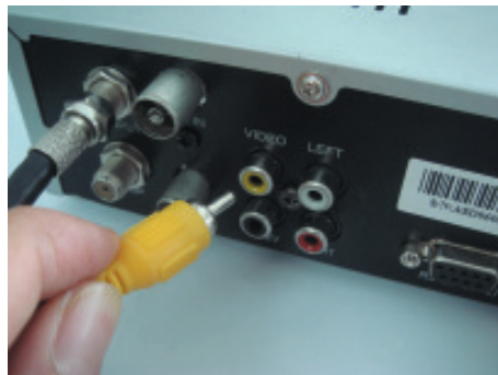
2. ต่อสาย AV โดยต่อสายหัวสีเหลืองเข้าที่ Video
