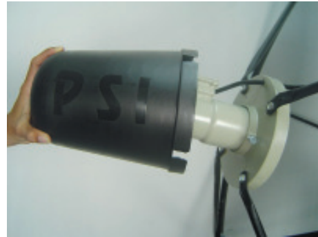
27. ครอบหมวกกับสกาล่าร์ริง โดยยึดติดกับก้านพีดี
