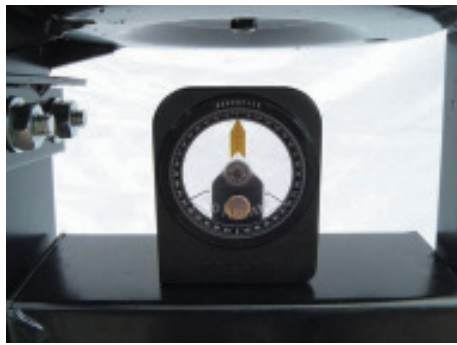
14. แกนไดเรกชั่น ต้องอยู่ในแนวระนาบตามรูป และเข็มต้องชี้ไปที่เลขศูนย์ (อย่าลืมเช็คค่าตัววัดมุมก่อนทุกครั้งที่ทำกรวัด)
