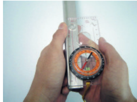
8. ดูเข็มว่าชี้เหนือใต้หรือไม่ ถ้าเข็มทิศยังไม่ชี้ไปทางทิศทางที่กำหนดแสดงว่ายังปรับหรือตั้งหน้าจานไม่ตรง
