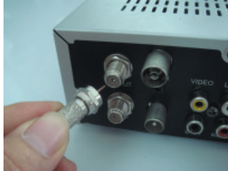
1. นำสาย RG6 ที่ต่อ F-type เรียบร้อยแล้ว ไปต่อเข้าที่ Input และหมุน F-type ให้แน่น
