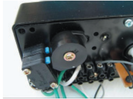
16. แกนขับเคลื่อนจะยึดออกไปไม่ได้ถ้าลูกเบี้ยวตัวนอกสุดไปแตะกับสวิทช์
