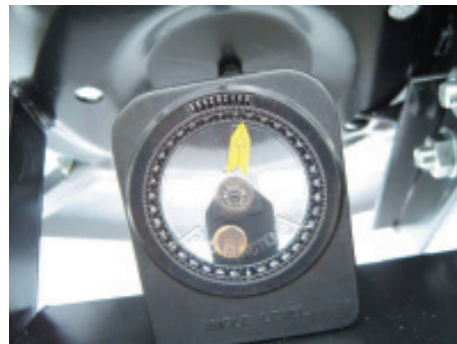
17. ให้สังเกตดูตัวเลขซึ่งมีขีดเล็กมากเมื่อเข็มชี้ไปตรงกับตำแหน่งที่เราคำนวณได้แล้ว ก็ให้ทำการขันน็อตล็อคให้พอดีมือ
