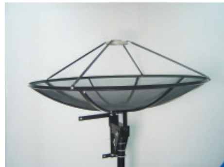
17. เมื่อใส่เสร็จแล้วจะเป็นตามรูปนี้ โดยหน้าจานจะต้องเงยขึ้นฟ้าและเมื่อวัดจะได้ตัวเลขศูนย์องศา ถ้าไม่ได้ ให้ปรับมุมก้มเงยให้ได้ก่อน (สำหรับผู้ที่ไม่เคยติดตั้งจานมาก่อนให้ท่านทำตามขั้นตอนนี้เพราะทุกขั้นตอนที่กล่าวไว้จะมีมุมที่สอดคล้องกันเพื่อให้รับภาพได้เมื่อจบขบวนการหากเมื่อเราติดตั้งจนชำนาญแล้วท่านอาจจะปรับวิธีการได้)
