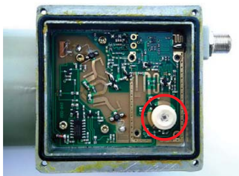
ภายใน LNB C-band มี OSC=5150 MHz
