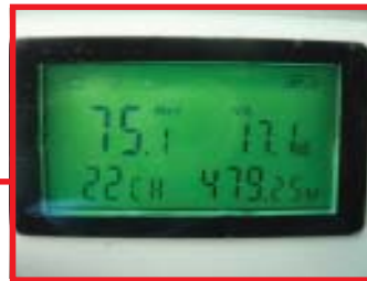
ภาพการทดสอบความแรงของสัญญาณหลังจากติดตั้งเสร็จ
